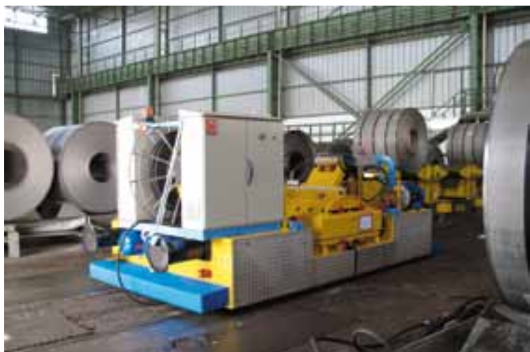
CARRI PER LA MOVIMENTAZIONE SICURA DI COIL DI LAMIERA DA 35T/CAD.
